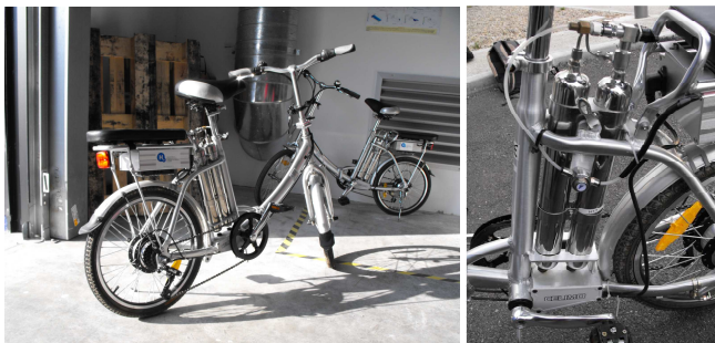
Fig. 1 Bicicleta eléctricamente asistida con hidrógeno Fundación para el desarrollo de nuevas tecnologías del hidrógeno en Aragón Parque tecnológico WALQA, Huesca - España
